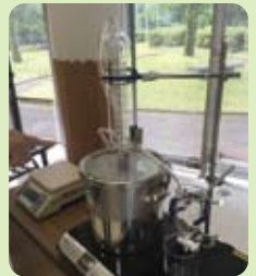
エッセンシャルオイルを精製する水蒸気蒸留装置です。まるで理科の実験器具みたいですね。
