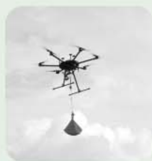
5kgの土のうを運搬するドローン
