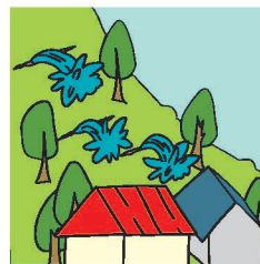
斜面から水が噴き出す。
